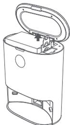
Ziehen Sie den Griff des Staubbeutels nach oben, um den Staubbeutel zu entfernen
